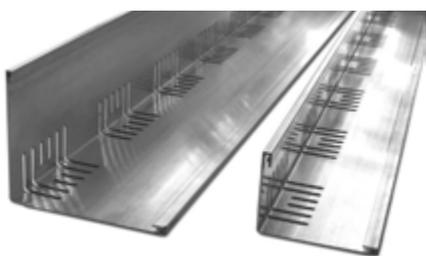
Perfil angular con ranuras de drenaje en su esquina, utilizable por ambos lados, fabricado de aluminio natural; para la separación de los diferentes sistemas, como por ejemplo las franjas de grava y las áreas vegetadas o franjas de Zincolit o similar.
