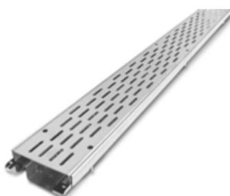
Canaletas fabricadas en acero inoxidable de alta calidad. Son regulables en altura entre 40 mm – 55 mm aprox., las tapas disponen de ranuras longitudinales y el cuerpo de la canaleta dispone de ranuras en los laterales y base. También tiene conector de juntas. Anchura de la canaleta 10,7 cm aprox.
