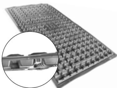
Placa base completamente premontada, de plástico rígido reciclado con cavidades, con perfiles y contra-perfiles de aluminio para reforzar situados en la cara inferior. Material de la placa: ABS; altura del elemento: aprox. 43 mm; peso incluidos perfiles de refuerzo: aprox. 7 kg; volumen de relleno: aprox. 16 l/m<sup>2</sup>. Medios de sujeción de acero inoxidable; rosca M10.
