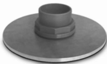
Elemento de retención para colocar en desagües de cubiertas planas con un diámetro mínimo interior de 100 mm (DN 100). Peso: aprox. 4,6 kg. Formado por una base circular de acero inoxidable con una junta de goma que impide el paso del agua en la parte inferior, diámetro aprox. 280 mm, y un rebosadero de plástico ajustable en altura, diámetro interior aprox. 75 mm, altura de retención ajustable de aprox. 10–75 mm.
