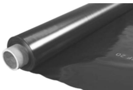
Manta de polietileno de alta presión químicamente neutral, utilizable como capa separadora y deslizante en cubiertas vegetales o cubiertas transitables; tolerable al betún y al poliestireno; resistente a la mayoría de los productos químicos; estabilizado a rayos UV; superficie lisa; bloqueo de vapor ( $sd \geq 100$  m); color: negro; grosor: aprox. 0,20 mm; peso: aprox. 190 g/m<sup>2</sup>.
