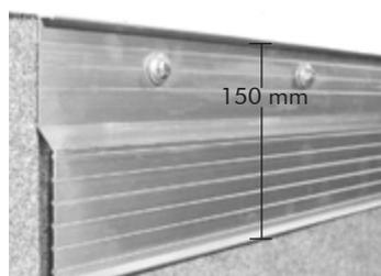
Perfil de fijación y de protección contra la radiación ultravioleta y las influencias de la intemperie; para láminas impermeabilizantes y bituminosas. Fabricado de aluminio natural; prensado por extrusión; con gran superficie de apoyo; según las directivas para cubiertas planas; preperforado cada 20 cm aprox.; altura del perfil: aprox. 150 mm.
