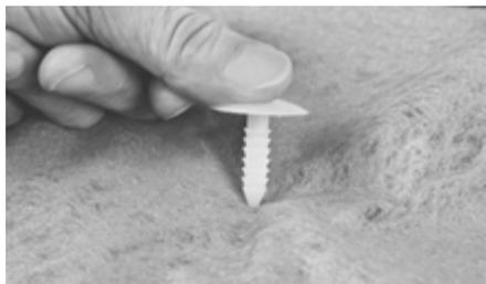
Realizado en polietileno, sirve para sujetar por varios puntos los filtros sobre todos los elementos de drenaje de espuma rígida de EPS (Floraset®). Se necesita aprox. 1 botón/m<sup>2</sup>. Diámetro de la cabeza: aprox. 30 mm; diámetro de la espiga: aprox. 8 mm; longitud de la espiga: aprox. 34 mm.
