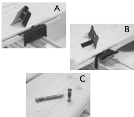
A: Clip de borde de acero galvanizado para tableros en terrazas de madera o de WPC. Clip de borde para tableros con 9 mm de profundidad de ranura y 10 mm de altura de ranura.
