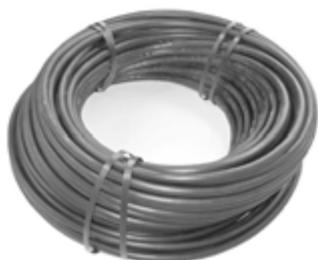
Tubería por goteo con goteros de compensación de presión integrados, para el riego en cubiertas verdes en combinación con el fieltro de distribución de agua AF 300; diámetro exterior de la tubería: aprox. 16,0 mm con goteros integrados en la tubería, distancia entre goteros aprox. 500 mm, capacidad de goteo aprox. 1,6 l/h; compensación de la presión: entre 0,4 y 2,5 bares.
