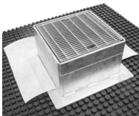
Caja de registro transitable con rejilla para desagües, de acero galvanizado al fuego, medidas exteriores de la caja 30 cm x 30 cm aprox.; dimensión exterior de la brida: aprox. 40 cm x 40 cm; con rejilla atornillada, ancho de mallas aprox. 11 mm x 41 mm; trampa de retención de arenas de aluminio y brida de apoyo que distribuye la presión; medidas de la abertura interior: 20 cm x 20 cm aprox.
