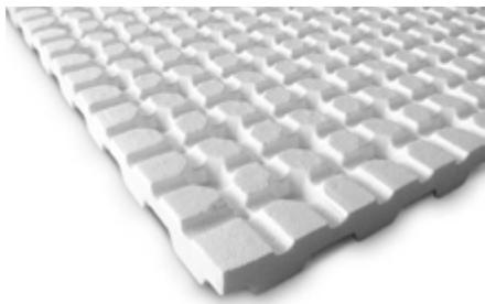
Placa de drenaje para la aplicación bajo ajardinamientos extensivos sobre cubiertas planas con y sin pendiente; de espuma rígida de EPS y sin HBCD; con concavidades de retención de agua, aperturas de aireación y difusión y un sistema de canales multidireccionales por su cara inferior; capacidad de drenaje testada según la normativa europea EN ISO 12958; densidad aparente: aprox. 20 kg/m<sup>3</sup>; peso: aprox. 0,6 kg/m<sup>2</sup>; altura: aprox. 50 mm.
