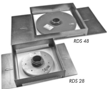
**Set RDS 48:** incluye la válvula reguladora RD 48 y la caja de control KS10/57 (véase página 25). Válvula reguladora ajustable, para ser instalada en cubiertas con pendiente 0° sobre salidas de agua con brida de sujeción; disco de PVC rígido; rebosadero regulable y anillos de ajuste fabricados de plástico; diámetro del dispositivo aprox. 480 mm; diámetro del tubo rebosadero aprox. 75 mm; altura máxima de rebosadero aprox. 85 mm; peso aprox. 4,5 kg.
