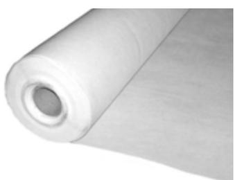
Lámina resistente al calor hecha de poliéster reforzado; se utiliza en la parte superior de Elastodrain® EL 202 para la instalación manual de pavimentos asfálticos. ¡Por favor, tenga en cuenta las instrucciones de instalación! Espesor: aprox. 1,0–1,4 mm; peso: aprox. 200 g/m<sup>2</sup>; resistencia a la tracción: min. 400 N/5 cm; dilatación de rotura longitudinal/transversal: aprox. 35/50 %; punto de fusión > 200 °C.
