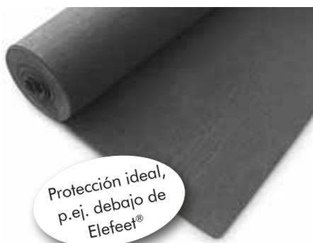
Manta protectora de alta calidad, de goma reciclada muy fina, de colocación continua sobre la impermeabilización de la cubierta. **La resistencia a la tracción de 0,8 N/mm<sup>2</sup> asciende a más del doble que otras mantas de composición similar; la dilatación de rotura con un 125 % asciende a más del triple.**
