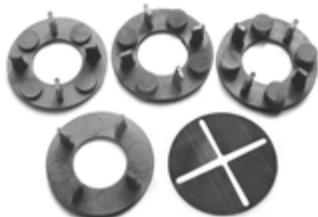
Anillos de caucho sintético para soporte de losas de pavimento. Tienen un diámetro de 120 mm, con alturas fijas de 5, 10, 15 y 20 mm. Con separadores para juntas integrados y de un espesor de 5 mm. El accesorio Elastoring se usa en superficies de cubiertas sin charcos. Ligeras desigualdades de la superficie de la cubierta se podrían compensarse con los anillos de diferentes alturas y las arandelas distanciadoras de 1 mm de espesor.
