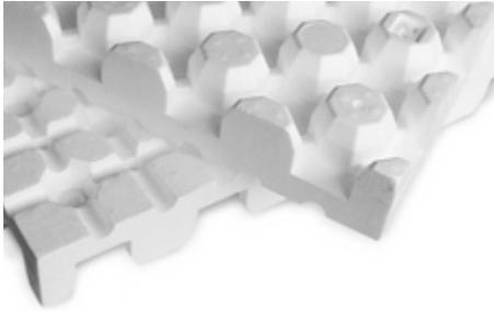
Los elementos Floraset® FS 75 forman la parte principal de la estructura del sistema "Cubierta inclinada hasta 20°". Los elementos FS 75 se fabrican de poliestireno expandido (EPS), en el lado superior tienen nódulos que retendrán el sustrato y disponen de canaletas de drenaje en el lado inferior; volumen de relleno (con los nódulos grandes hacia arriba): aprox. 20 l/m<sup>2</sup>; peso: aprox. 1,0 kg/m<sup>2</sup>; altura: aprox. 75 mm.
