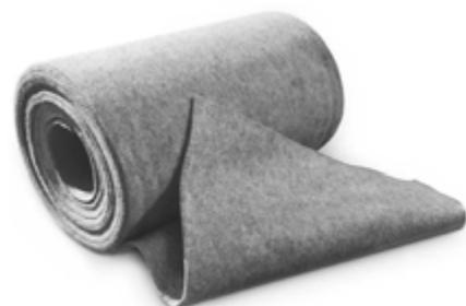
Bandas protectoras de fibras de poliéster previstas para el uso en bordes de cubiertas y de conexión, apropiadas especialmente para la combinación con Fixodrain® XD 20. Como ayuda para el montaje, pulverizada con adhesivo por el reverso; resistente al betún; química y biológicamente neutral; grosor: aprox. 3 mm; peso: aprox. 320 g/m<sup>2</sup>.
