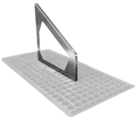
Soporte de base hecho de una sola pieza de aluminio, estructuralmente probado; adaptado a la ZinCo Base Solar SB 200; uso variable tanto para montaje estándar como para orientación este-oeste y para ajustes verticales. Se pueden elegir inclinaciones entre 5° y 45° en pasos de 5°. Peso: 2,6–3,0 kg/unidad; material AlMg III; color: aluminio natural.
