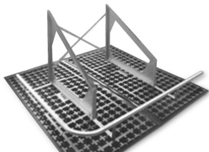
Sistema de railes para montar en combinación con la Base Solar SB 200 de ZinCo, con el soporte de base solar SGR o con la base de barandilla GB/Ángulo GB, con un punto de anclaje (o anillo corredizo) deslizable horizontalmente, homologado como equipo de protección anticaída sin perforación de la impermeabilización según la normativa EN 795:2012 tipos D y E.
