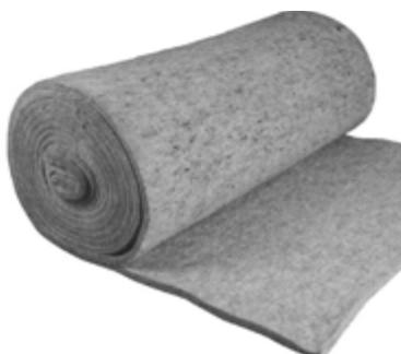
Manta de fibras sintéticas, termofijada, punzonada; no degradable; útil como manta retenedora bajo ajardinamientos extensivos, especialmente para cubiertas inclinadas; compatible con betún; química y biológicamente neutral; resistente al desgarro; fabricada con fibras sintéticas recicladas. **Capacidad de retención de agua: aprox. 12 l/m<sup>2</sup>; grosor: aprox. 17 mm; peso: aprox. 1500 g/m<sup>2</sup>.**
