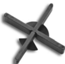
Con estos separadores para juntas de un grosor de 3 mm puede garantizarse una imagen homogénea de las juntas también en los sitios, donde no se puede colocar un soporte elevador Elefeet® debajo del punto en cruz de las losas (p.ej. en el área de soportes a inglete y de bordes); cuarta pata del separador de fácil extracción, sin necesidad de herramientas.
