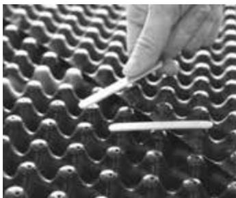
Pensados para unir con seguridad las placas Floradrain® colocadas a tope; funcionan introduciéndolos a presión en las perforaciones de difusión; realizados en plástico amarillo. Se necesitan unos 2 clips/m<sup>2</sup>.
