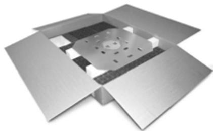
Dispositivo de anclaje anticaída sin necesidad de perforación de la impermeabilización, lastrado con peso según la normativa EN 795: 2012 tipo E, compuesto de elementos modulares conectados entre sí formando una base sobre la que se asienta sustrato o gravilla y un punto de anclaje con ojal ubicado en el interior de la placa.
