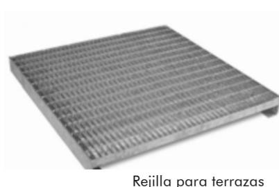
Se pueden colocar rejillas para terrazas fabricadas de acero galvanizado al fuego, con ancho de malla aprox. 44 x 11 mm, en lugar de las losas de hormigón de pavimento, cuando nos encontremos encima de los desagües de la cubierta o bien con la ayuda de brazos-soporte a lo largo de la fachada y se hace posible un paso rápido del agua pluvial por el espacio que hay debajo del pavimento.
