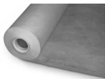
Filtro de polipropileno endurecido térmicamente **con gran resistencia a las cargas mecánicas**; aplicable especialmente sobre terraplenes de drenaje; permeabilidad ( $H_{50}$ ) según normativa EN ISO 11058: aprox. 40 l/(m<sup>2</sup> × s); abertura de poro ( $O_{90}$ ) según normativa EN ISO 12956: aprox. 85 μm; clase de resistencia 3; peso: ≥ 175 g/m<sup>2</sup>.
