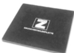
Se coloca la placa distribuidora de la presión directamente debajo del Elastoring para proteger el nivel de impermeabilización de altas cargas puntuales y los correspondientes daños. Con la placa de 200 × 200 mm de goma se eleva la estructura en aprox. 4 mm.
