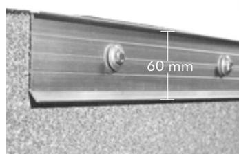
Perfil de fijación según las directivas para cubiertas planas 4.2.1 para sujetar láminas impermeabilizantes y bituminosas; fabricado de aluminio natural; prensado por extrusión; con ancha superficie de apoyo; preperforado cada 20 cm aprox.; altura del perfil: 60 mm.
