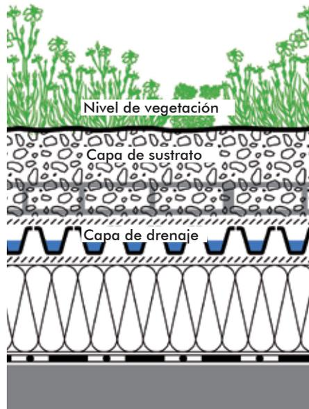
**Espesor de la estructura:** aprox. 13 cm
