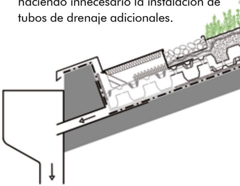
En caso de desaguar a través de bajantes, éstos deben ser instalados junto al peto perimetral manteniendo una distancia de separación de 30 cm (rellenada con gravas) del área vegetada, según indican las directrices del FLL.
