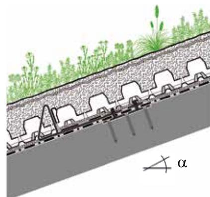
Los soportes antiempuje LF 300 en combinación con el perfil de alero TRP 80 permiten la construcción de barreras de retención en la superficie de la cubierta verde.
