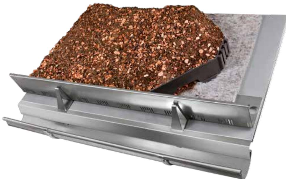
Con el sistema constructivo "Cubierta inclinada hasta 35°" que se basa en los elementos del ZinCo-Georaster® nos permite ajardinar superficies de cubierta con pendientes superiores a los 25°. Los elementos Georaster de polietileno reciclado (HD-PE) tienen unas dimensiones de 54 x 54 cm y una altura de 10 cm y se encajan entre ellos fácilmente sin herramientas. Se consigue inmediatamente una adherencia firme en toda la superficie.
