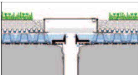
En caso de precipitaciones abundantes, el agua se acumula en el área de retención del elemento espaciador hasta el borde superior de la válvula reguladora.
