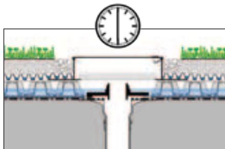
La escorrentía del agua se produce a través de los orificios de la válvula reguladora en un período de tiempo preestablecido (p.ej., en 24 horas) ...
