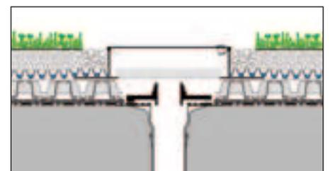
La cubierta reguladora de cargas pluviales cuenta con una válvula reguladora del flujo sobre el sumidero. Dicha válvula dispone de una abertura en su cara inferior ajustable al tamaño del desagüe y un tubo rebosadero regulable en altura.
