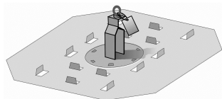
Punto de anclaje con placa identificativa, poste y ojal de anclaje
